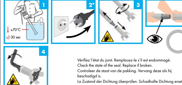
Vérifiez l'état du joint. Remplacez-le s'il est endommagé.
